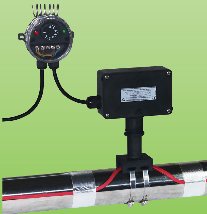
Beispiel für die Montage an 2 Begleitheizungskabeln, mit einem Y29 Anschlusskasten, für Metallrohr-Frostschutz
